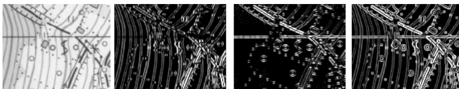
4.25. ábra. Balról jobbra: 1. Az eredeti kép. 2.-3. A kép x és y irányú gradienseinek közelítése a gradiens szűrő segítségével. 4. Az előző két képből előállított élkiterjedés
